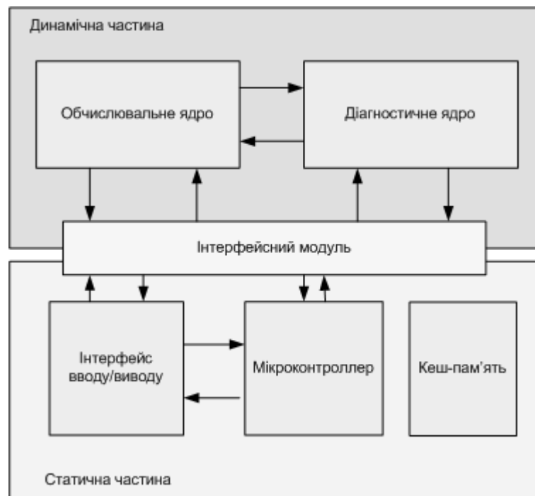
Рис. 1. Структурна схема реконфігурованого обчислювального елемента на базі ПЛІС
