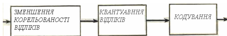
Рис. 1. Блок-схема системи зменшення надлишковості відеоінформації.
