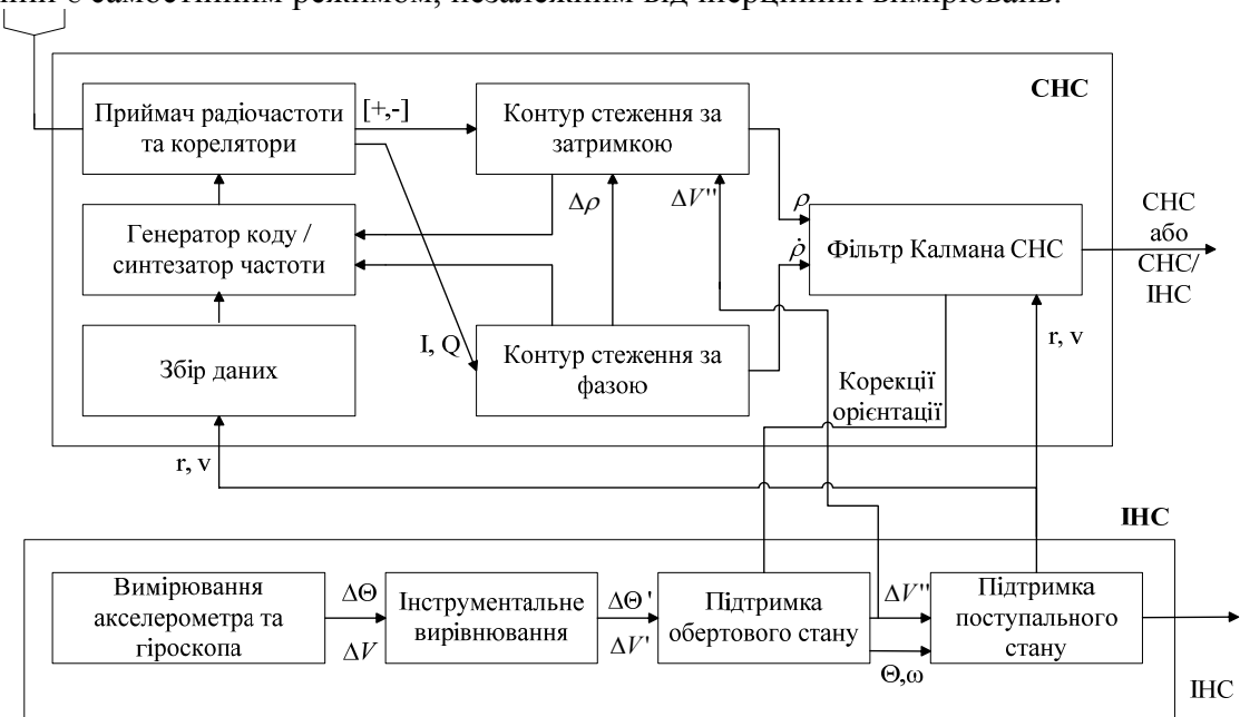
Рис. 4 Слабко зв'язана система за MAGR-схемою
