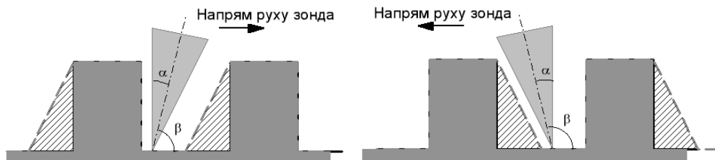
Рис. 3. Траєкторія проходження зонда над поверхнею а) в прямому напрямку, в) в зворотному напрямку
