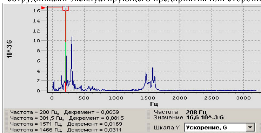
Рис.1 Программа SHOCK для определения частот и коэффициентов затухания собственных колебаний
