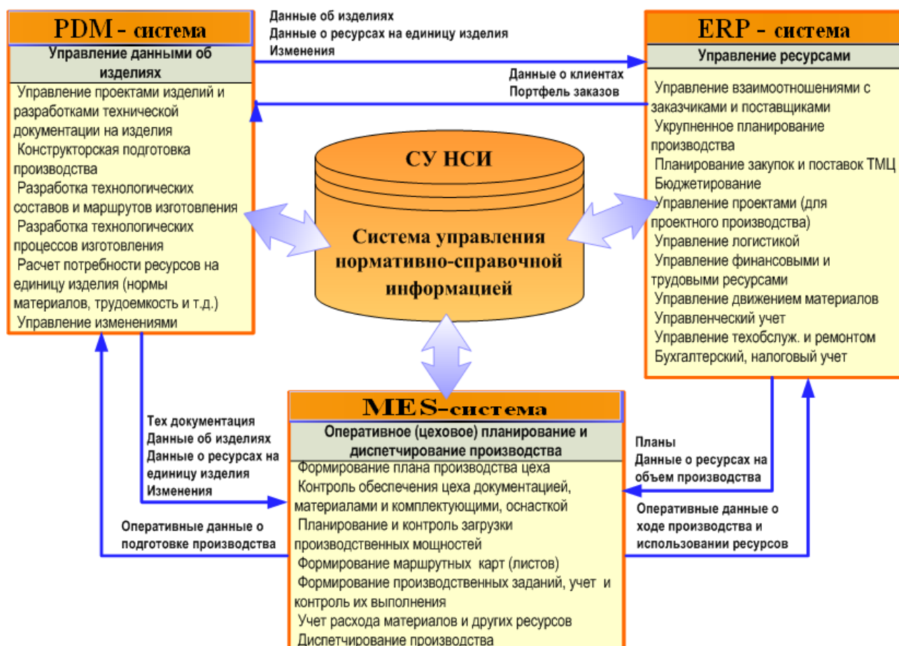
Рис.4. Концептуальная модель интегрированной информационной системы управления машиностроительным предприятием с многономенклатурным производством.
