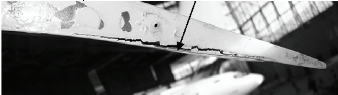
Рис. 2. Пример отслоения обшивки сотовой панели
