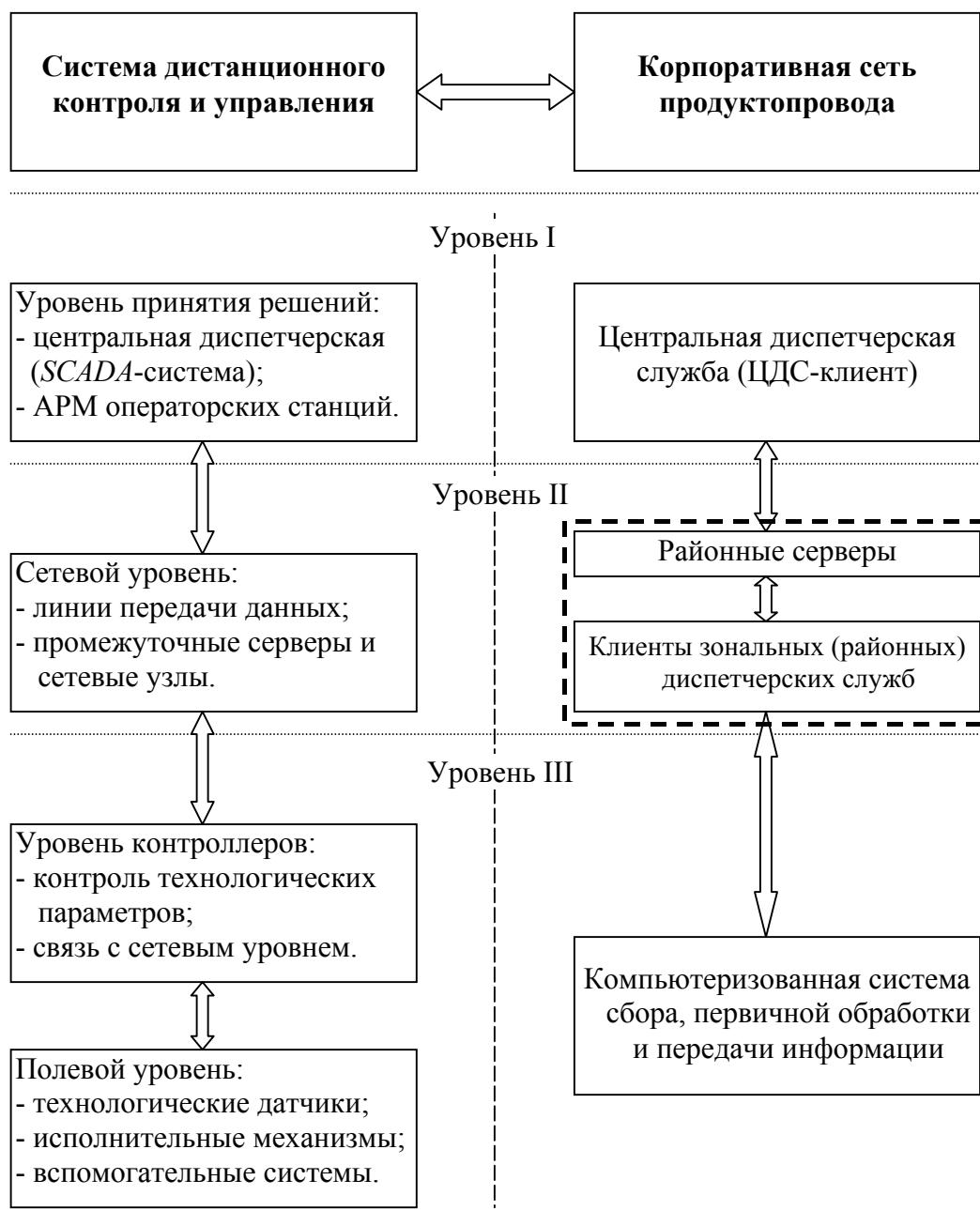
Рис. 1. Многоуровневая иерархическая система управления продуктопроводом.
