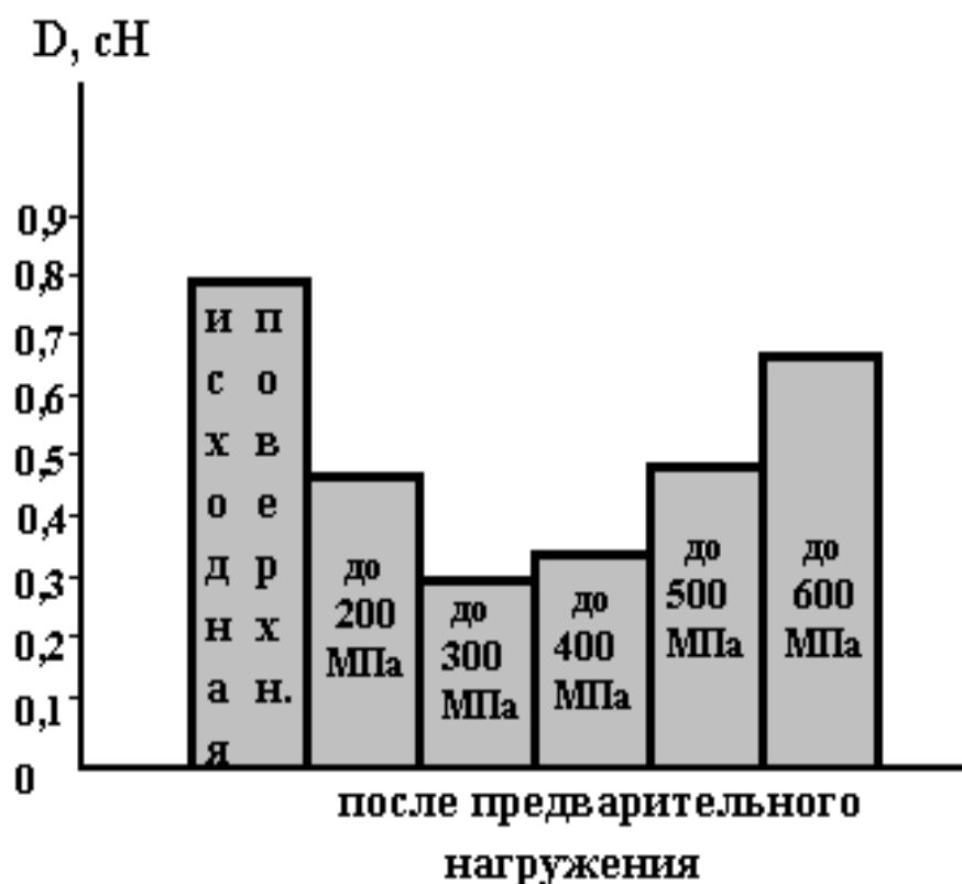
Рис. 2. Гистограмма дисперсии глубины внедрения индентора по трассе сканирования ( D ) (нагрузка на индентор p = 60 г, длина трассы сканирования L = 2 мм)
